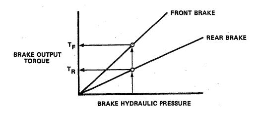
Figure 2.5-17 DESIGN RELATIVE FRONT/REAR BRAKE CAPACITY
