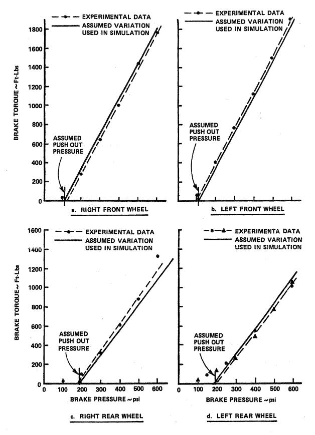
Figure 2.5-8 BRAKE TORQUE VS HYDRAULIC PRESSURE
