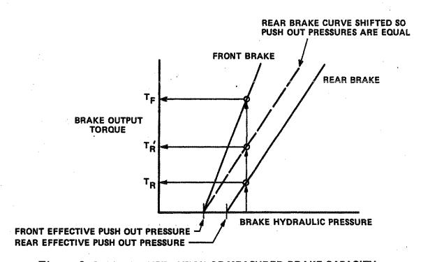
Figure 2.5-18 ILLUSTRATION OF MEASURED BRAKE CAPACITY
