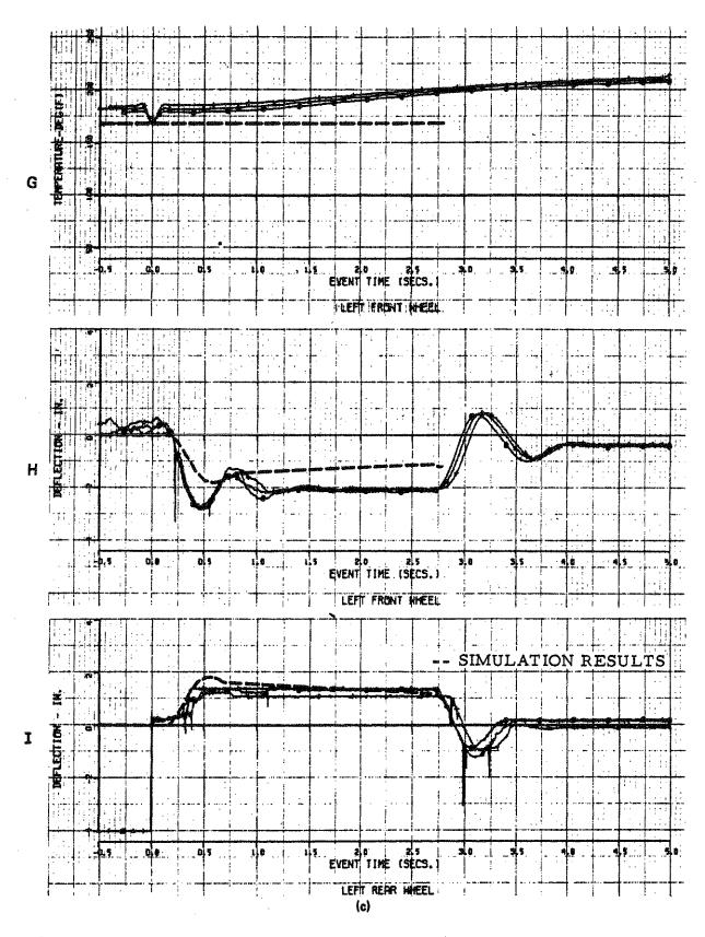
gure 2.5-14 (Cont.) COMPARISON OF MEASURED AND COMPUTED VEHICLE RESPONSES — STRAIGHT AHEAD BRAKING MANEUVER
